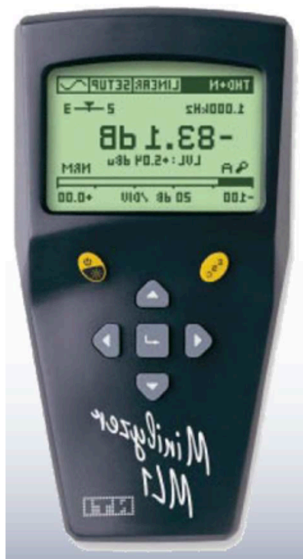
Slika 12: Minilyzer ML1 NTI – sprejemnik indukcijske zanke + merilnik za vse njene osnovne parametre
